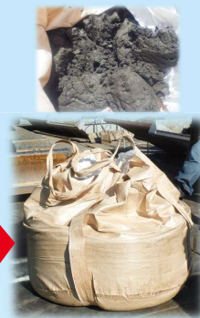
上段:脱水後の汚泥 下段:脱水後自立状態
