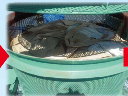
上段:分離水排水 下段:加圧後透水性バッグ
