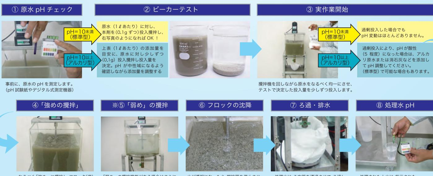
なるべく「強め」に攪拌し、フロック(塊)ができるたら「弱め」の攪拌とします。
